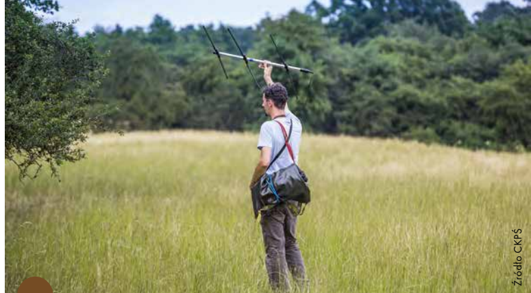
Monitoring z wykorzystaniem odbiornika i nadajników telemetrycznych
